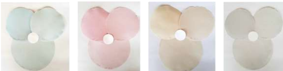
Abb. 21: Undeinkte (links oben) und deinkte (rechts oben) Nutschenblätter sowie Laborblätter (unten) und Filter (mitte) des Deinkingversuchs vom Einzelfarbdruck von MÖF F2 auf Papier P1.
